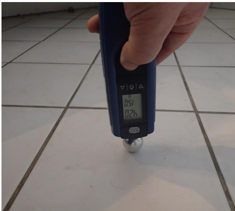
Foto nr. 16 Badeværelse. Fugtmåling midt på gulv.
